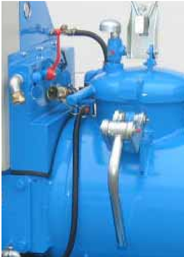
Luftarmatur mit Kesselluft- und Förderlufteinsteller, Domdeckel mit Sicherheitsverschluss
