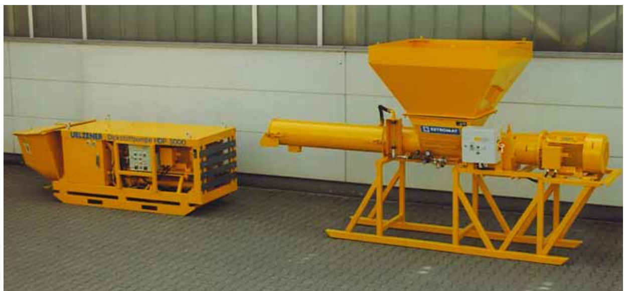
ESTROMAT 403 mit Big-Bag-Aufgabetrichter, Kufengestell und stationärer Hochdruckkolbenpumpe UELZENER HDP3000.
