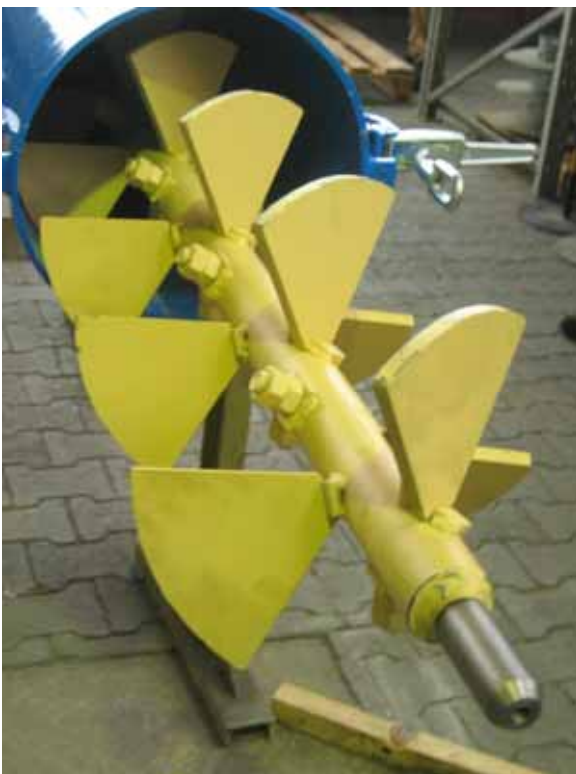
ESTROMAT 403 Anwendung zum Mischen von Staubresten aus der Quarzsandherstellung
