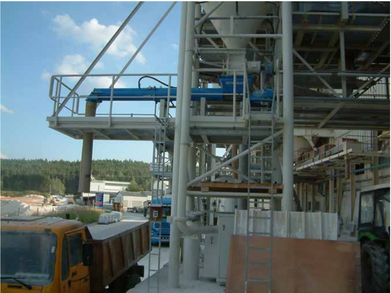
ESTROMAT 403 Anwendung zum Mischen von Staubresten aus der Quarzsandherstellung
