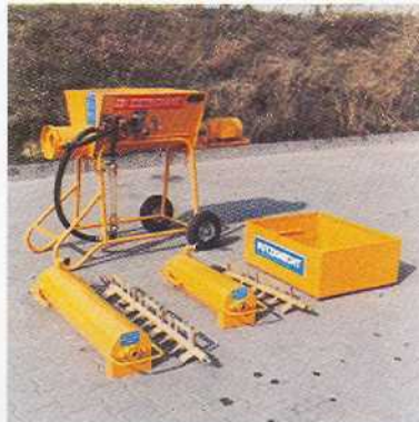
Die Mischzeit kann durch verschieden lange Mischrohre und -wellen dem zu verarbeitenden Mörtel optimal angepasst werden. Ein Aufsatz vergrößert das Volumen des Vorratsbehälters um ca. 100 Liter.
