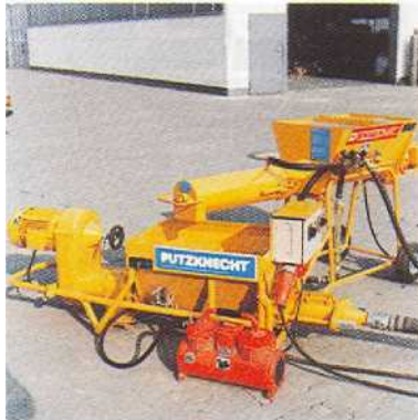
Mit der Maschinenkombination ESTROMAT 404, Mörtelpumpe PUTZKNECHT S 30 und Kompressor lassen sich auch schwierige Mörtelarten, wie z. B. Kellenwurf (0-8 mm) problemlos mischen, pumpen und spritzen.
