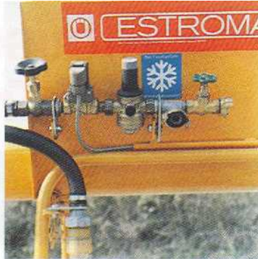
Die in Griffhöhe montierte Wasser-Dosier-Armatur sorgt für eine genaue und gleichmäßige Mörtelkonsistenz.
