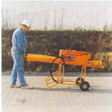
Auf der Baustelle lässt sich der Durchlaufmischer bequem wie eine Schubkarre schieben.
