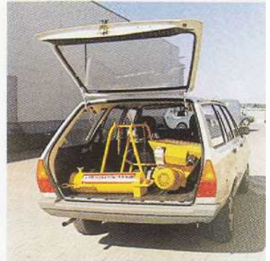
Mit wenigen Handgriffen ist der ESTROMAT 404 in vier Teile zerlegbar - Mischrohr - Mischwelle - Untergestell - Vorratsbehälter - und passt bequem in einen PKW.
