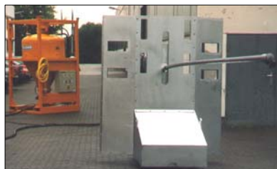
< Lanzenwagen mit elektromotorisch verfahrbarem Untergestell und 10 m – Spritzlanze.
