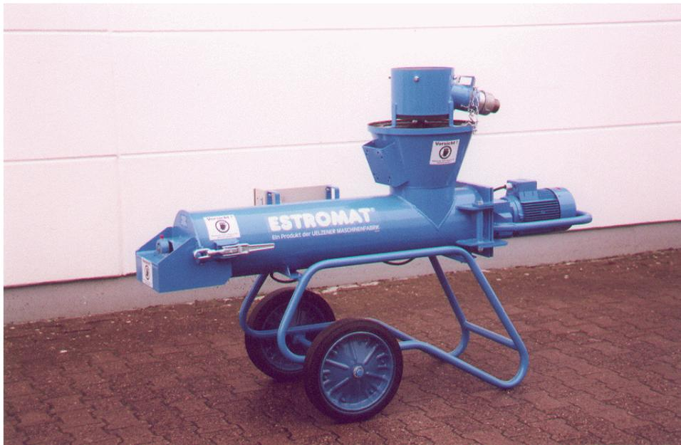
**Einsatzgebiet:** Der Nachmischer ESTROMAT 402-NM wird im Anschluss an die pneumatische Förderung der Misch- und Förderkesselmaschinen ESTROMAT 165, 264, 260-600 und 850 und anderen Fabrikaten zur Verbesserung und Homogenisierung des Fördergutes eingesetzt.
