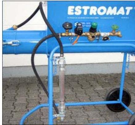
Die in Griffhöhe montierte Wasser-Dosierarmatur sorgt für eine genaue und gleichmäßige Mörtelkonsistenz.
