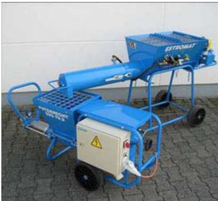
Mit der funktionellen Maschinenkombination ESTROMAT 404, Mörtelpumpe PUTZKNECHT S 30 und Kompressor lassen sich schwierig zu verarbeitende Mörtelarten z.B. Kellenwurf (0-8mm) problemlos mischen, pumpen und spritzen.
