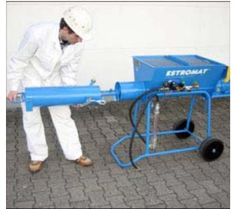
Die Reinigung des ESTROMAT 404 ist denkbar einfach - Mischrohr und Mischwelle mit Wasser abspritzenfertig!
