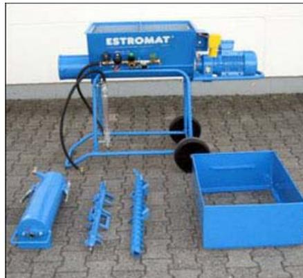
Die Mischzeit kann durch verschiedenen lange Mischrohre und -wellen dem zu verarbeitenden Mörtel optimal angepasst werden. Ein Aufsatz vergrößert das Volumen des Vorratsbehälters um ca. 100 Liter.
