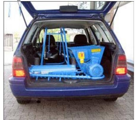
Mit wenigen Handgriffen ist der ESTROMAT 404 in vier Teile zerlegbar - Mischrohr - Mischwelle - Untergestell - Vorratsbehälter - und passt bequem in einen PKW.
