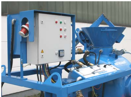
Ergonomischer Arbeitsplatz mit elektrischer Steuerung, Schalt- und Überwachungsgeräte, sowie Wasserdosier- und Luftarmatur
