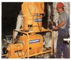
Ein PUTZKNECHT S30 arbeitet unter Als hergestellt und 100 m weit gepumpt, um Bohrlöcher zu verfüllen. Für Einsätze im Untertagebetrieb wird die Mörtelpumpe mit Motoren der erforderlichen Schutzart oder Druckluftantrieb ausgerüstet.
