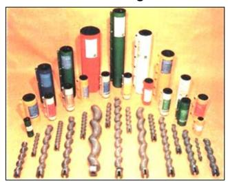
In sechs Baugrößen steht zur Bestückung des PUTZKNECHT S 30 eine Vielzahl von Schneckenpumpen zur Auswahl. Je nach Leistung des Antriebsmotors und dessen Drehzahl werden Fördermengen von 1 l/min bis 100 l/min bei Drücken bis 60 bar erzielt. Ein weit gefächertes Leistungsspektrum, das jeden Einsatzbedingungen gerecht wird. UELZENER Schneckenmäntel sind in weicher und harter Gummiqualität, nachstellbar oder wartungsfrei lieferbar.
