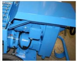
Unter einer Abdeckhaube geschützt, Das Herz des PUTZKNECHT S 30 ist findet der robuste Regelgetriebeantrieb\* des PUTZ-KNECHT S 30-R210 Platz, Je nach Bedarf kann die Förderleistung zwischen 20 -100% stufenlos verstellt 8 mm Körnung gefördert, durch Mörtelwerden. \*(auch mit FU lieferbar)
