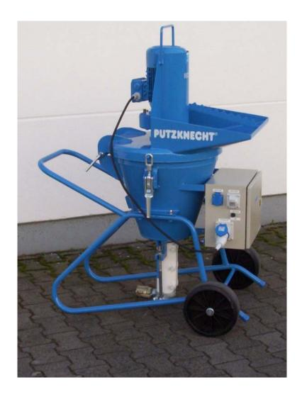
Der PUTZKNECHT S36 findet überall da Anwendung, wo Mischpumpen, wie z.B. PUTZKNECHT S48 und S58 wegen der hohen Leistung nicht eingesetzt werden können, oder Spezialmörtel mit langer Mischzeit oder Quellzeit verarbeitet werden sollen. Durch das einfache Funktionsprinzip <Rechts>-Mischen, <Links>-Pumpen hat der Anwender die Möglichkeit, das Mischgut bereits vor der Verarbeitung zu begutachten und den Mörtel auf die gewünschte Verarbeitungskonsistenz einzustellen. Das erspart teure Mörtelverluste.
