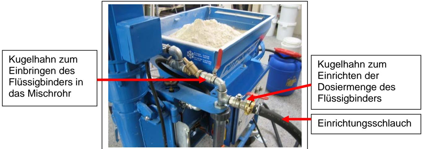
Einrichtungsschlauch an die dafür vorgesehene Kupplung anschließen. Kugelhahn zum Einbringen des Flüssigbinders in das Mischrohr schließen und den Kugelhahn zum Einrichten der Dosiermenge des Flüssigbinders öffnen.
