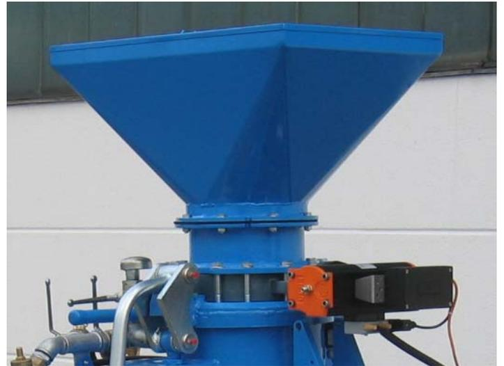
Die halbautomatisch betätigte Drehklappe dient als Verschluss des Druckkessels während der Förderung. Sie erlaubt eine schnelle Befüllung mit den Komponenten des Mischgutes und ermöglicht durch die pneumatische Betätigung ein schnelles Schließen und Öffnen und damit eine höchstmögliche Leistung der Misch- und Fördereinheit.
