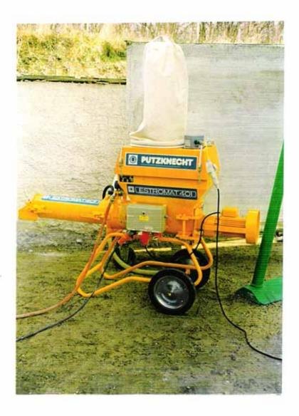
Die gesamte ESTROMAT 401H eco 6 ist auf ein baustellengerechtes Maschinengestell mit zwei großen Rädern, Ø400 mm, aufgebaut.
