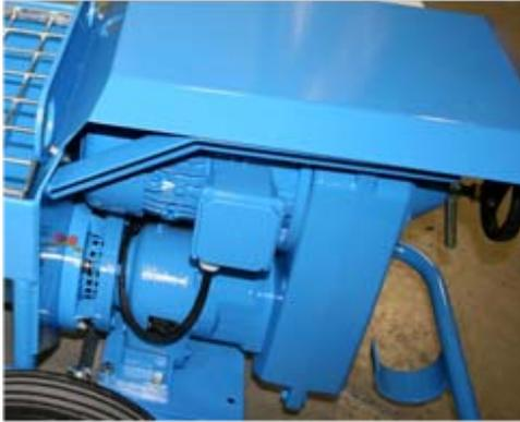
Unter einer Abdeckhaube geschützt, findet der robuste Regelgetriebeantrieb\* des PUTZ-KNECHT S 30-R210 Platz. Je nach Bedarf kann die Förderleistung zwischen 20 -100% stufenlos verstellt werden. \*(auch mit FU lieferbar)
