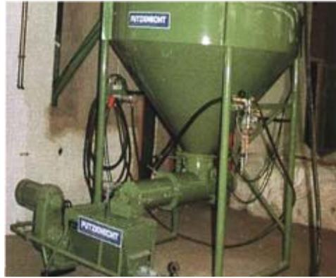
Als stationäre Anlage findet der PUTZKNECHT S 30 mit einem Durchlaufmischer ESTROMAT 401 z.B. in einer Teppichfabrik Anwendung. Vollautomatisch wird Füllbeton gemischt, zur Vermörtelungsanlage gefördert zur Herstellung von Hohlraumfußboden-Matten.
