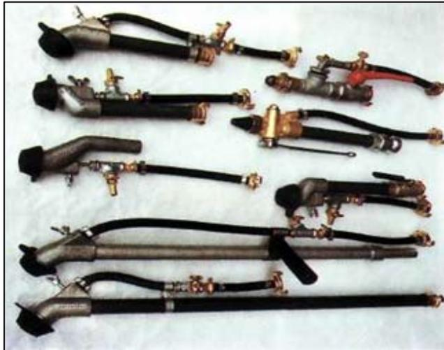
Handlichkeit und geringes Gewicht zeichnen die UELZENER Spritzgeräte aus, die in Ihrer Typenvielfalt jeden Putzmörtel optimal anspritzen. Abgestimmt auf die verwendeten Mörtelleitungen sind verschiedene Geräte erforderlich, wenn der PUTZKNECHT S 30 bei Verputzarbeiten eingesetzt wird. Des weiteren sind Spritzgeräte für die Betonsanierung bis zum Beton-Naß-Spritzverfahren für große Durchsatzmengen im Lieferprogramm.
