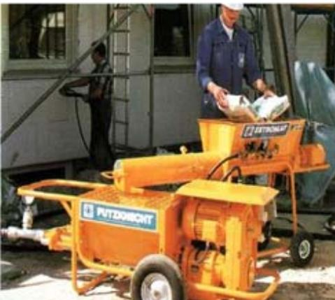
Durchlaufmischer ESTROMAT 404 und Mörtelpumpe PUTZKNECHT S 30, sind das ideale Gespann bei der Verarbeitung von Fertigmörtel. Mit wenigen Ausnahmen können alle maschinengängigen Mörtel verarbeitet werden.
