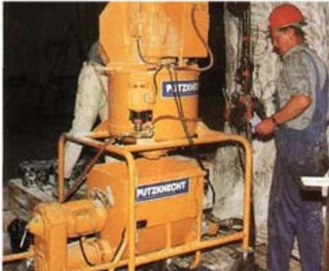
Ein PUTZKNECHT S30 arbeitet unter extremen Bedingungen im Salzbergwerk. Im Tellermischer wird ein Salzbeton hergestellt und 100 m weit gepumpt, um Bohrlöcher zu verfüllen. Für Einsätze im Untertagebetrieb wird die Mörtelpumpe mit Motoren der erforderlichen Schutzart oder Druckluftantrieb ausgerüstet.
