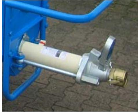
Das Herz des PUTZKNECHT S 30 ist die UELZENER Schneckenpumpe. Zuverlässig und mit langer Lebensdauer werden je nach Pumpentyp Medien bis 8 mm Körnung gefördert, durch Mörtel-schläuche DN25, DN35 oder DN50.
