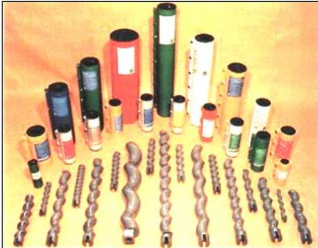
In sechs Baugrößen steht zur Bestückung des PUTZKNECHT S 30 eine Vielzahl von Schneckenpumpen zur Auswahl. Je nach Leistung des Antriebmotors und dessen Drehzahl werden Fördermengen von 1 l/min bis 100 l/min bei Drücken bis 60 bar erzielt. Ein weit gefächertes Leistungsspektrum, das jeden Einsatzbedingungen gerecht wird. UELZENER Schneckenmäntel sind in weicher und harter Gummiqualität, nachstellbar oder wartungsfrei lieferbar.
