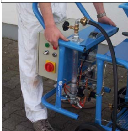
Haut: stator facilement démontable Gauche: Coffret électrique démontable pour le transport ou autre
