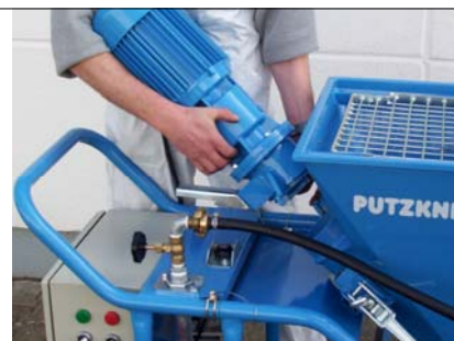
Le moteur est basculé sur le côté pour le nettoyage de la trémie et du tube de malaxage
