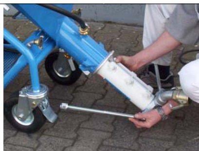
Haut: stator facilement démontable Gauche: Coffret électrique démontable pour le transport ou autre
